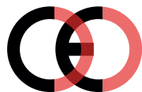
Marcatura CE contraffatta (troppo vicino)
